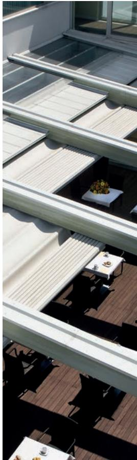
Impact<sup>®</sup> è il sistema di copertura brevettato da Corradi, composto da un telo impermeabile denominato Eclissi, che scorre su apposite guide ed è sostenuto da tubi in alluminio. Utilizzato su tutte le strutture Corradi, Impact<sup>®</sup> può essere applicato anche a pergolati o strutture preesistenti.
